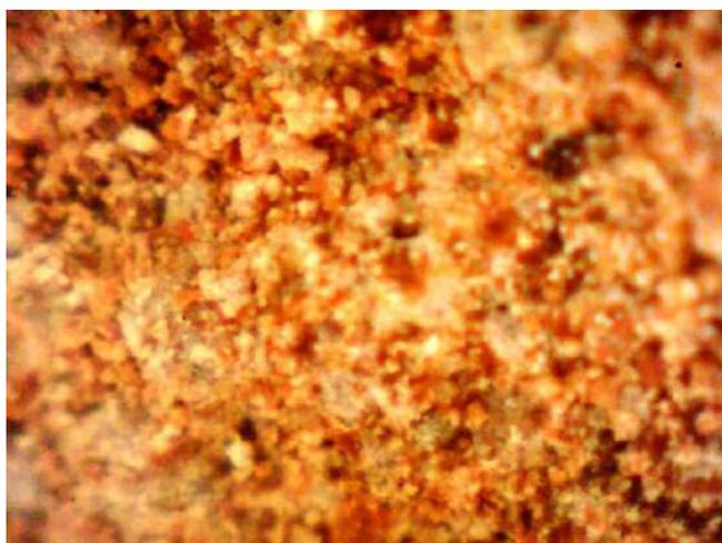
Fig. 6 Estructura del suelo-cal CH-I 10% compactado (x200).
