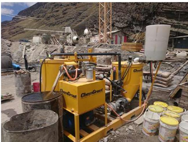
Fig. 1. Equipo de inyección Chem Grout.
